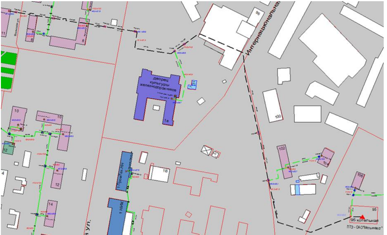
Рисунок 3...154 – Трассировка теплопровода от котельной ОАО «Мельинвест» по ул. Интернациональная, д. 95 до конечного потребителя «ПТ-Вольск,11»
